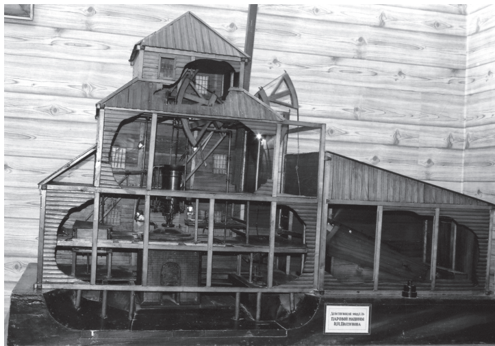
Действующая модель паровой машины Ивана Ползунова
